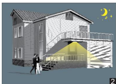
夜晚感应器自动启动，有人进入感应区，自动开启照明灯具。
